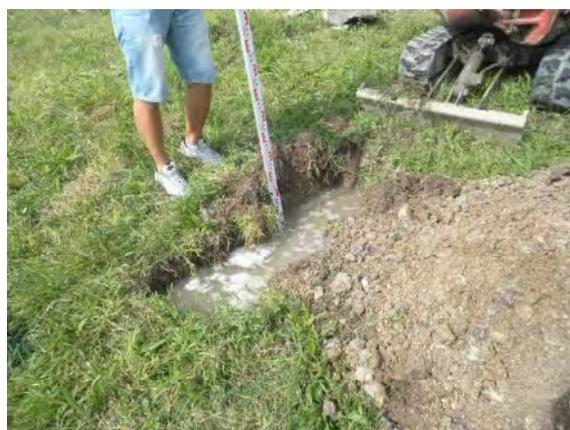
*I livelli idrici all'interno del pozzetto hanno raggiunto un'altezza max di 0,88 m.*
