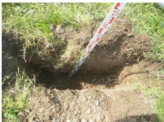
*Fase di preparazione del pozzetto di prova delle dimensioni di 1,05 x 0,35 x 1,10 m.*
